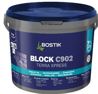
Wasser gestoppt ist. Bei sehr starkem Wasserdruck oder größerem Wasserstrahl **BLOCK C902 TERRA XPRESS** mit viel Wasser schnell zu einer dicken Paste anrühren und sofort als Pfropfen zum Verschluss des Wassereintruchs verwenden. Bei der Verarbeitung als Komponente im Spezialabdichtungssystem AQUASTOPP wird mit **BLOCK C902 TERRA XPRESS** die erste Schicht der **BLOCK C901 TERRA SPECIAL** trockengerieben. Bei der Verarbeitung sind als Arbeitsschutz profillöse Handschuhe zu tragen.
