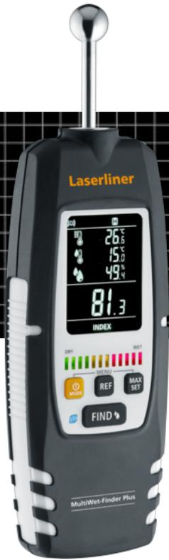
**Elektronisches Materialfeuchtemessgerät zur Lokalisierung und Beurteilung von Feuchtigkeitsverteilungen und Feuchtigkeitsschäden in Wand, Boden oder Decke**
