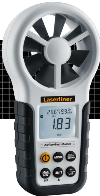
**Anémomètre professionnel pour la mesure du courant atmosphérique, du débit volumétrique et de la vitesse du vent**
