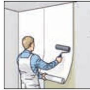
**4.** Placer les lés dans le lit de colle en éliminant les bulles d'air et les plis à l'aide d'un rouleau maroufleur en caoutchouc ou d'une brosse à tapisser.
