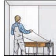
**2b.** Encollage à l'aide d'une encolleuse sans détrempe. Pour l'encollage, utiliser de la colle à intissé.
