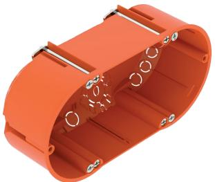
Doppelte Hohlwand-Gerätedose für den Einsatz in Hohlwänden mit einer Einbautiefe von mindestens 47 mm und einer Plattenstärke von 5 - 40 mm.
