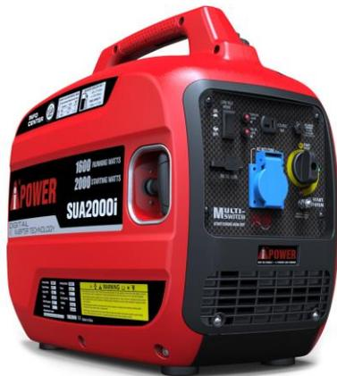
Der solide Benzin Inverter Generator bietet eine Startleistung von 2.000 Watt und eine Betriebsleistung von 1.600 Watt. Er wird durch einen 80 ccm Benzin Motor angetrieben.
