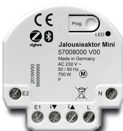
Jalousieaktor zum Ansteuern von elektrischen Jalousien oder Rollläden. Das Modul besitzt zwei Eingänge zum Anschluss von Jalousie-Schaltern oder -Tastern. Die Installation erfolgt in der Gerätedose hinter dem Schalter/Taster oder im Jalousie-Rollladenkasten direkt beim Motor. Konfiguration und sofortiger Funktionstest über die Taste Prog.
