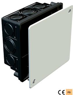
Verbindungskasten für das Verklemmen von Klemmen, mit Deckel und Deckelschraube (15 mm), Deckelrand liegt plan auf, Oberfläche ist aufgeraut, in Verbindung mit Deckel und Deckelschrauben erreichen die Verbindungsdosen das VDE-Prüfzeichen nach VDE 0606 und werden flammwidrig nach VDE 0471/DIN 695 Teil 2-1, Prüftemperatur 750 °C, Schutzart IP20.
