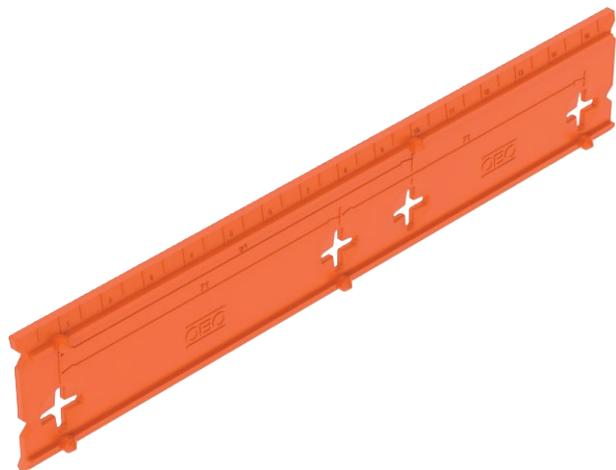
Bohrschablone für Unterputz- und Hohlwand Dosen. Zum Anzeichnen der Befestigungsabstände von 71 oder 91 mm. Mit Markierungshilfen zum Vorkörnen und mit Kerben zum Ausrichten an z. B. Schlagsschnurmarkierungen.
