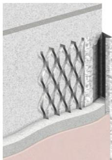
Das Putzabschlussprofil besteht aus gestrecktem Edelstahl und wird zur Abgrenzung zu anderen Bauteilen und Werkstoffen oder auch zur Fugenausbildung eingesetzt. Putzabschlussprofile sorgen für exakte Kanten und planebene Flächen und stellen saubere und optisch ansprechende Kanten her.
