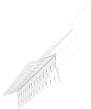
Das Eckschutzprofil wird im Trockenbau für Spachtelarbeiten in Verbindung mit Gipskartonplatten verwendet. Es besteht aus schlagzähem Hart-PVC. Durch sein flexibles Mittelteil kann man das Profil für Winkel von 50° bis 180° einsetzen. Außerdem lässt sich MULTI extrem leicht auf jede beliebige Länge anpassen. Nach dem Motto: Abmessen – Anpassen – Anbringen. Durch die praktische Verpackung als Rolle bleibt das Profil geschützt und kann leicht und einfach transportiert werden.
