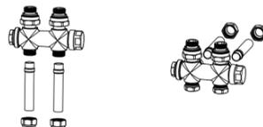
2. Rimuovere il connettore maschio (A) dal corpo della valvola e poi avvitare nell'ingresso e uscita del titolare radiatore, posizionare il corpo della valvola sull'ingresso e l'uscita, e quindi serrare con il dado di raccordo precedentemente allentato.
