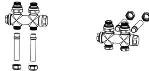
2. Nehmen Sie den männlichen Anschluss (A) vom Ventilkörper ab und schrauben Sie diese direkt in den Heizkörper Einlass und Auslass. Setzen Sie das Ventil an den Einlass und Auslass und sichern Sie diese dann mit der Überwurfmutter. Wie folgt:
