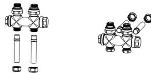
2. Ta av den manliga kontakten (A) från ventilkroppen, och sedan skruva den in i radiatorhållaren inlopp och utlopp. Placera ventilkroppen på inloppet och utloppet och då spänna med den tidigare lossade union muttern.
