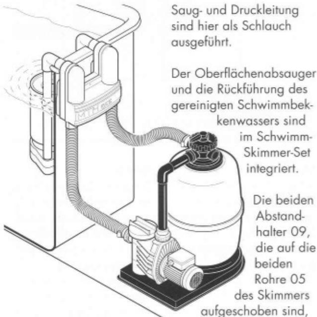
Saug- und Druckleitung sind hier als Schlauch ausgeführt.
