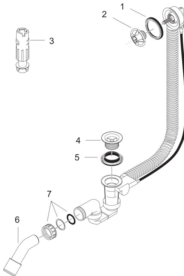
**Grundkörper für Flexaplust Fertigeset mit Ab- und Überlaufgarnitur für Sonderwannen**
