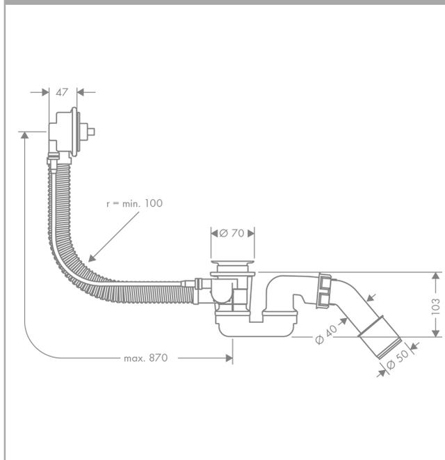
**Grundkörper für Flexaplust Fertigeset mit Ab- und Überlaufgarnitur für Sonderwannen**
