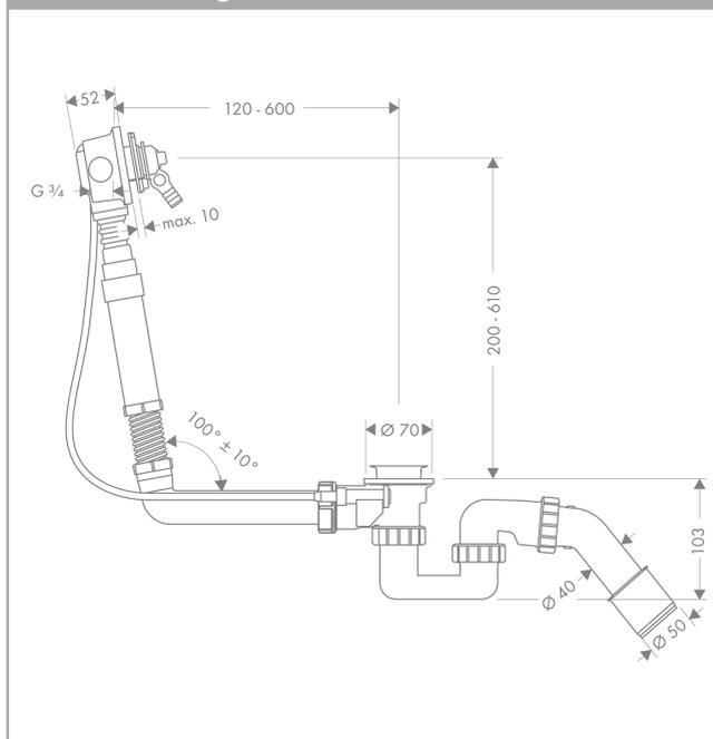
**Grundkörper für Exafill Wanneneinlauf Fertigset mit Ab- und Überlaufgarnitur für Sonderwannen**
