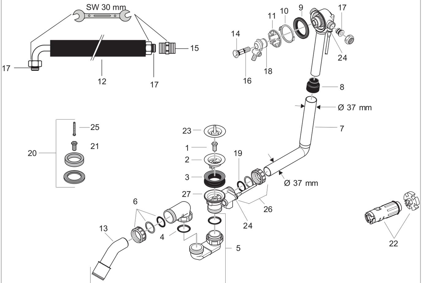
**Grundkörper für Exafill Wanneneinlauf Fertigset mit Ab- und Überlaufgarnitur für Sonderwannen**
