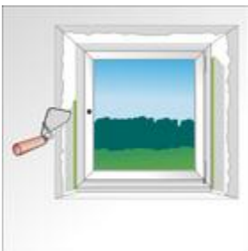
Bild 13: Einputzen und glattstreichen
