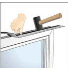
Bild 14: Geeignete Kederfolie in die äußeren Blendrahmen-Nuten einbringen
