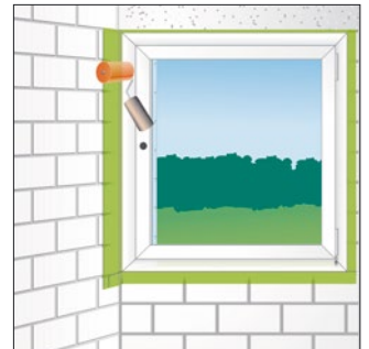
Bild 10: Folie mit Andruckroller anrollen
