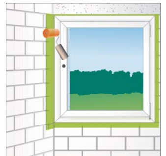
Bild 8: Folie mit Andruckroller anrollen
