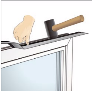
Bild 14: Geeignete Kederfolie in die äußeren Blendrahmen-Nuten einbringen
