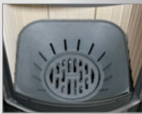
Chambre de combustion avec auge en fonte et grille à secousse
