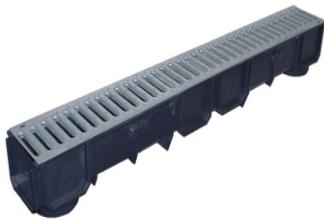
Entwässerungsrinne, aus PP, mit einem großen Auffangvolumen und durch verschiedene Anschlussmöglichkeiten sehr flexibel. Rost aus verzinktem Stahl mit Self-Lock-System. Hohe Tragkraft, Klasse A 15 und sehr stabil. Abgang für Rohranschluss ist angeformt.
