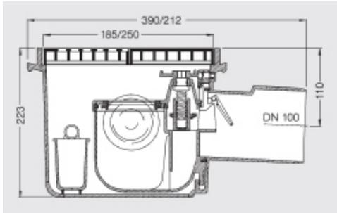
**Kellerablauf mit Rückstau-Dreifach-Verschluss**, mit Dreifach-Rückstauverschluss nach DIN EN 13564 und DIN EN 1253 für fäkalienfreies Abwasser. Der Rückstauverschluss verhindert das Zurückfließen von Abwasser bei Rückstau in der Kanalisation. Er ist stets in betriebsfähigen Zustand zu halten und muss jederzeit zugänglich sein. Bei längeren Betriebsunterbrechungen empfiehlt es sich, den Handverschluss geschlossen zu halten. Ablauf Anschluss DN 110 an HT/KG Rohr (Muffe).
