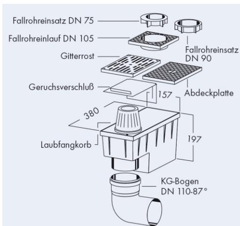
**Regensinkkasten RSK 2000** für die einfache und schnelle Reinigung von Fallrohren. Der RSK 2000 verhindert Verstopfungen. Er hat einen senkrechten Anschluss DN 110 und wird inkl. eines KG-Bogens DN 110 mit 87° geliefert. Es können Fallrohre von DN 75 bis DN 110 angeschlossen werden. Der RSK verfügt ebenfalls über einen Geruchsverschluss und einen Laubfangkorb.
