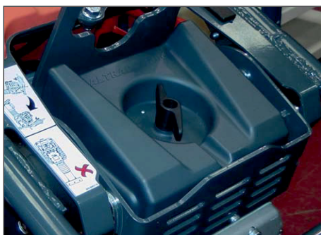
3-faches Luftfilter System für eine hohe Zuverlässigkeit.
