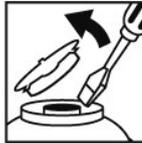
Entfernen Sie die Sprühsicherung indem Sie zuerst den Sprühkopf abnehmen. Führen Sie einen Schraubenzieher zwischen Lasche und Sicherungsring ein. Hebeln Sie mit einer Abwärtsbewegung die Sicherung sanft heraus.
