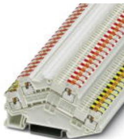
Doppelstockklemme, für KNX-Bus in der Gebäudeinstallation, paarweise (25 Paare = 50 Stück) verpackt, Anschlussart: Push-in-Anschluss, Querschnitt: 0,14 mm<sup>2</sup> - 1,5 mm<sup>2</sup>, AWG: 26 - 14, Breite: 7 mm, Farbe: weiß, Montageart: NS 35/7,5, NS 35/15
