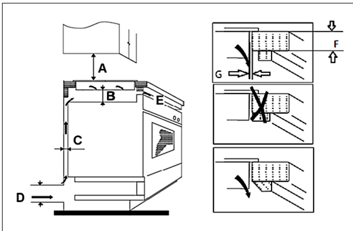
**C = BELÜFTUNGSSCHLITZ**
