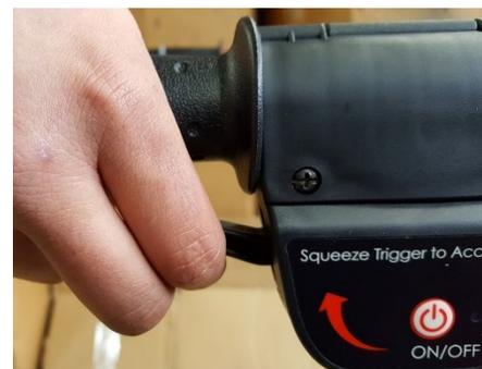
2. Zum Anhalten des Elektro-Schneeräumers lassen Sie den Hebel des Geschwindigkeitsreglers ab (Bild 23).
