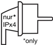
Der Spritzwasserschutz ist nur gewährleistet, wenn Stecker der gleichen Schutzart (IP44) angeschlossen werden und dieser komplett eingesteckt ist!
