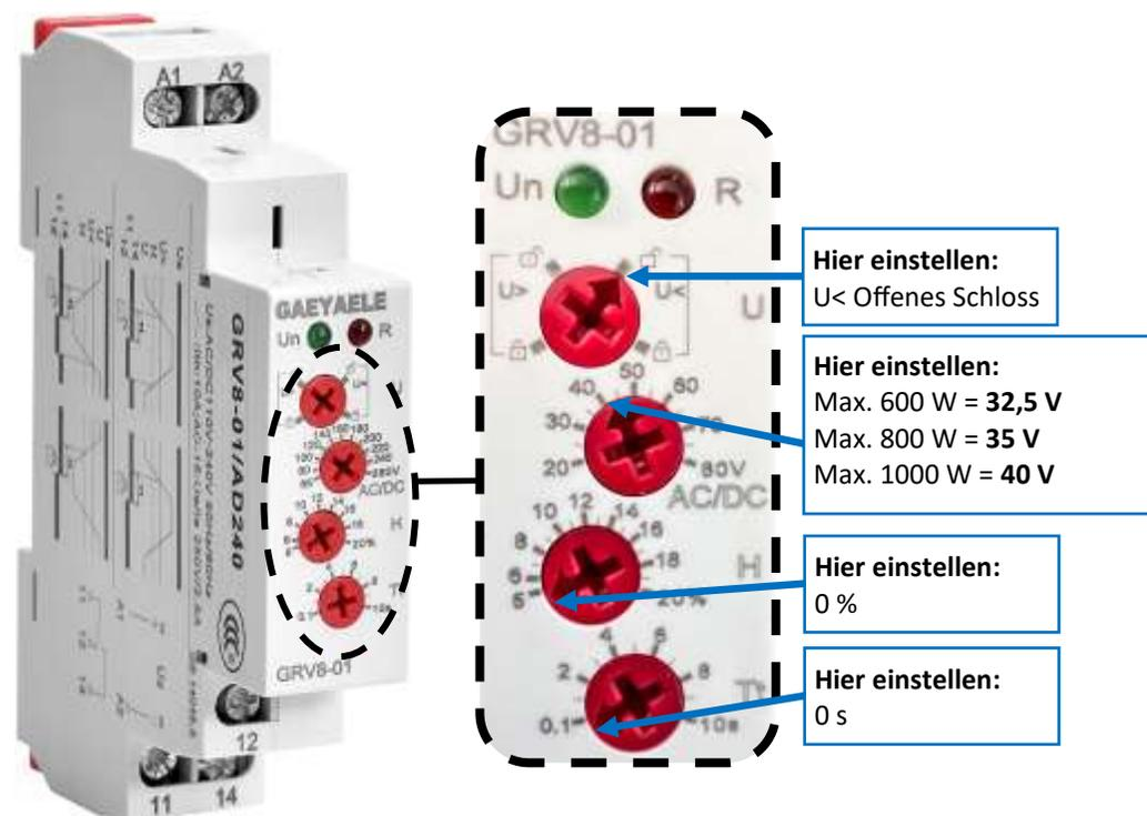
Das **GRV8-01 Steuergerät** misst ständig die DC-Arbeitsspannung der Windkraftanlage und schaltet bei Überschreitung des kritischen Höchstwertes von max. 40 V DC das GRT8-B1 Zeitrelais. Stellen Sie es gemäß dieser Vorgaben ein.
