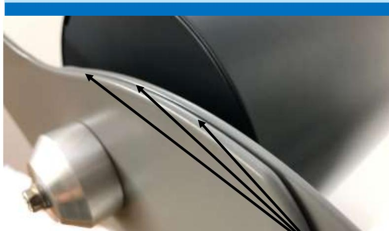
Achten Sie unbedingt darauf, dass **die beiden Rotorblätter exakt übereinander liegen!** Abweichungen bedeuten eine Unwucht und führen zu lauten Geräuschen Gondelschütteln und Materialschäden bis zum Rotorabriss! Nur das Aufstecken anhand der Nut ist nicht ausreichend! Setzen Sie Rotorsets immer wie geliefert ein. Maximale Toleranz Rotorgewicht 12,5 g zwischen beiden Rotorhälften. Vor Montage auswiegen und protokollieren.
