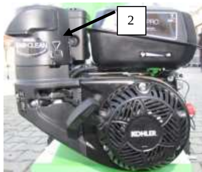
Luftfilter mit Fliehkraftfunktion zur Separation der Verunreinigungen und Filtereinsatz (2) unter der Haube
