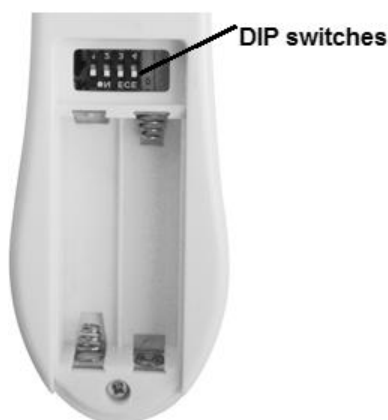
Fig. 10 Vano batterie telecomando
