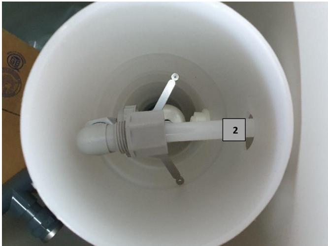
2. Soleschlauch vom Steuerkopf zum Salzbehälter
