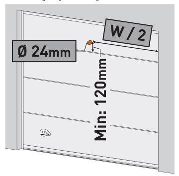
**1.2)** Positionieren Sie die Teile der Notentriegelung. Legen Sie das angeschlossene Kabel an das Ende des Zylinderschloss durch die Bohrung mit 24 mm Durchmesser von der Außenseite des Tores. Setzen Sie die Notentriegelung ein und richten Sie sie auf die Bohrung im Tor aus.
