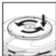
fig. 7 - mettre le nouveau cache en place
