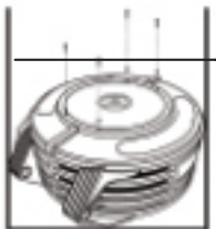
fig. 14 - apriete los tornillos
