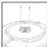
fig. 13 - serrer les vis
