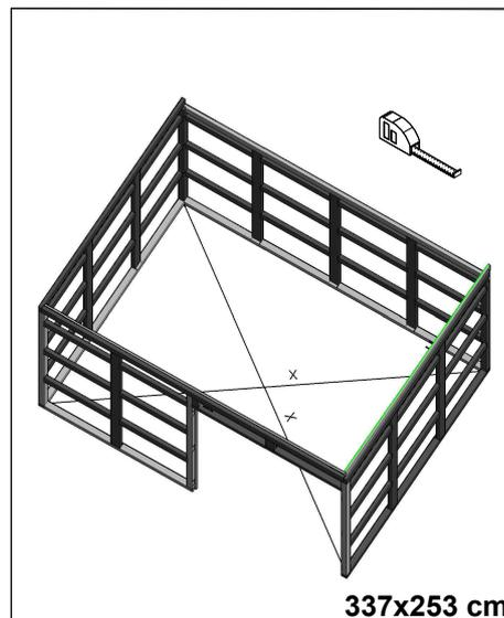
Vérifiez aussi les diagonales à l'aide d'un mètre ruban. Mesurer les diagonales à partir des coins opposés des madriers de seuil, les deux mesures doivent être égales.
