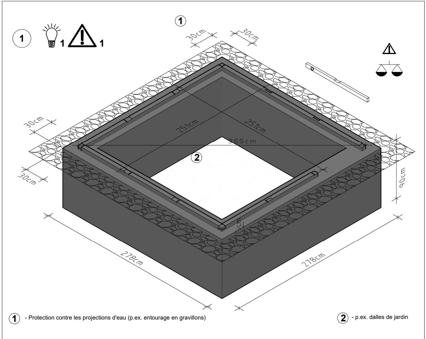
Préparez les fondations (b/h = 30/90cm) selon la statique (béton C25/30, X0, XC2, respectivement armature acier 2  $\varnothing$  12 en haut et en bas, étrier  $\varnothing$  6, e  $\leq$  20 cm) et entourez les fondations avec un chemin de bordure en gravillons d'environ 30 cm de large (protection contre les projections d'eau).
