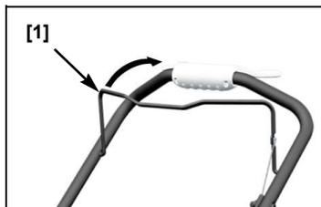
Halten Sie den Bügel der Messerkupplung weiter ganz an die Griffleiste herangezogen. Motor und Messer können so reibungsfrei drehen und einem vorzeitigen Verschleiß der Messerkupplung wird vorgebeugt.
