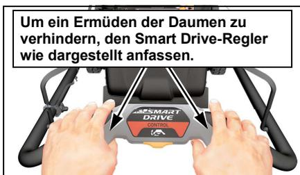
Die Fahrgeschwindigkeit nimmt zu, je mehr Druck Sie auf den Smart Drive-Regler ausüben. Sobald die maximale Fahrgeschwindigkeit erreicht ist, erhöht zusätzlicher Druck die Fahrgeschwindigkeit nicht weiter. Üben Sie nur so viel Druck aus, wie zum Erreichen der gewünschten Geschwindigkeit erforderlich.
