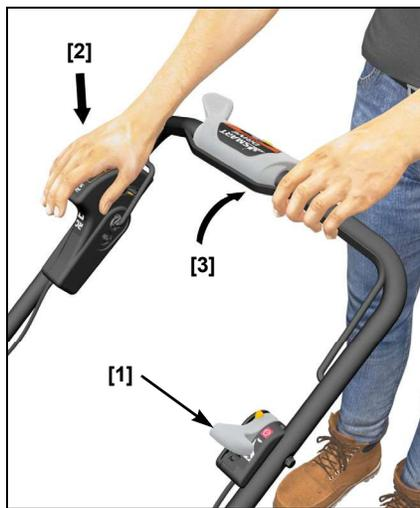
Halten Sie den Bügel der Messerkupplung weiter ganz an die Griffleiste herangezogen, damit sich die Messer weiter drehen. Der Messerkupplungsbügel muss immer vollständig gezogen oder vollständig freigegeben sein. Der Bügel darf nicht nur teilweise gezogen werden.
