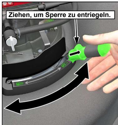
Wenn der Clip Director in Stellung MULCHEN steht, ist es normal, dass sich etwas Gras in der Auswurföffnung ansammelt. Um dieses Gras zu entfernen, die Auswurfklappe schließen, den Clip Director auf Position FANGEN stellen, den Messerkupplungsbügel zur Griffleiste ziehen und den Motor starten.
