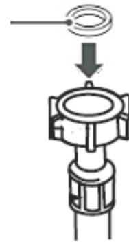
2. Befestigen Sie das **gerade** Ende des Wasserzulaufschlauchs an dem entsprechenden Wasseranschluss (s. Abb. rechts).
