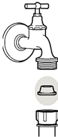
5. Installieren Sie den Wassereinlassfilter wieder im Schlauchende. Achten Sie darauf, dass sich die Dichtung (Gummi-Unterlegscheibe) ordnungsgemäß im Ventilanschluss befindet.
