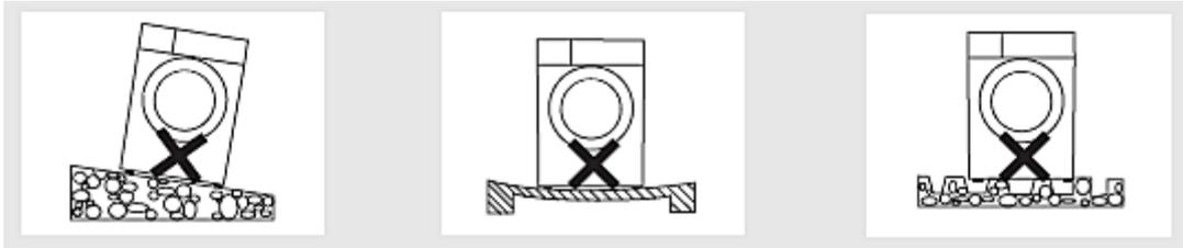
10. Falls Sie das Gerät auf einem Holzfußboden installieren, **müssen** Sie es zusätzlich auf eine **mindestens** 3,00 cm dicke Sperrholzplatte (60,00\*60,00 cm) stellen, um das Gewicht des Gerätes zu verteilen. Befestigen und sichern Sie die Sperrholzplatte ordnungsgemäß auf dem Holzfußboden.
