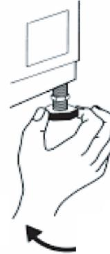
b. zum **Absenken** des Gerätes **nach rechts** drehen (s. Abb. rechts).
