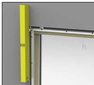
Rahmen in Bauöffnung einsetzen, mit den Montagekrallen ausrichten und leicht fixieren.
