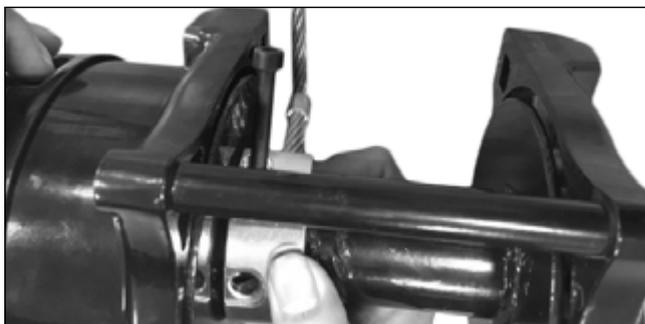
4. Setzen Sie die Schraube M6 X 65 ein und führen Sie sie aus einem anderen Loch heraus.
