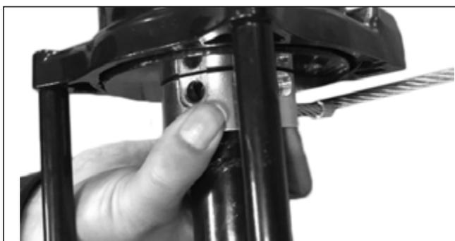
3. Drücken Sie die Klemme auf die Trommel und stellen Sie sicher, dass sich das Seil in der Nut der Muschel befindet. Stellen Sie die Löcher in Klemme und Trommel auf die gleiche Position ein.
