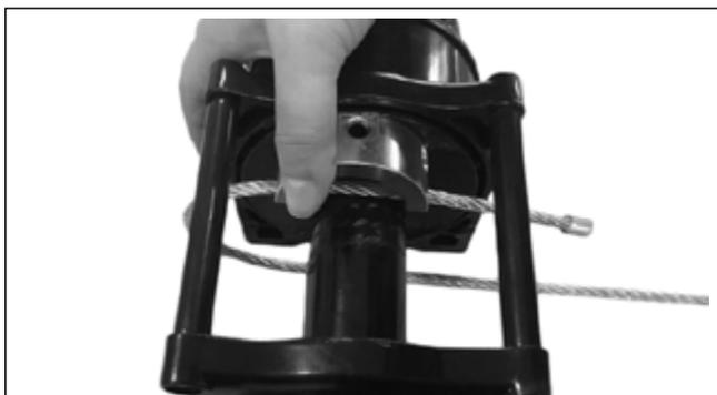
2. Stellen Sie die Trommel so ein, dass das Schraubenloch oben ist, legen Sie das Seil auf die Trommel und setzen Sie die Klemme auf das Seil (das Loch in der Nähe der Gießplatte)
