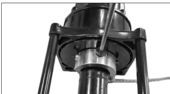
7. Schrauben Sie die M8 X 15-Schraube mit einem Schraubenschlüssel von der oberen Bohrung ein.
