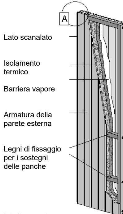
**Pertanto, prima di installare i singoli elementi è necessario osservare che la parte scanalata (vista dall'esterno) si trovi sempre a sinistra!**
