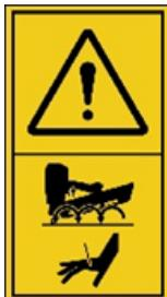
Marquage et avertissement pour les appareils avec déclencheur de contact.
