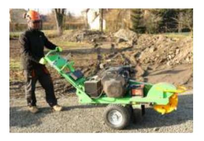
Zur Bedienung muss der Bedienende hinter dem Holm stehen (siehe Abbildung). Er muss den Betätigungsholm mit beiden Händen halten und einen festen Stand haben.
