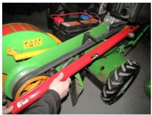
Kontrolle und Ausrichten der Riemenscheibe an dem Motor
