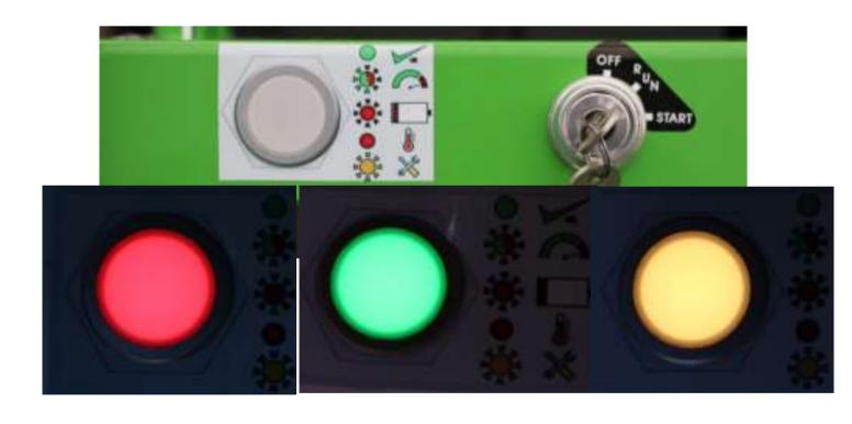
Die Baumstumpffräsen F 460EI (EIC) sind auch mit Warnleuchten versehen, die aktuellen Zustand der Fahrwerkregelung anzeigen. Zustand 1 --- alles OK: Fahrwerkregelung bereit und funktionsfähig --- grüne Warnleuchte EIN
