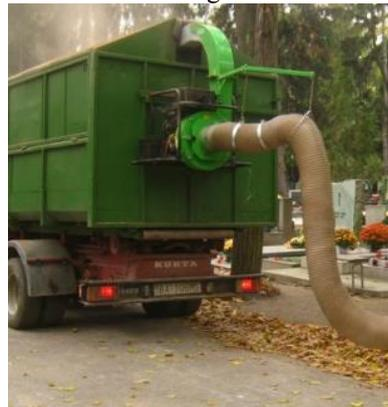
Richtige Verwendung des Laubsaugers in dem geschlossenen Container / Anhängeraufbau
