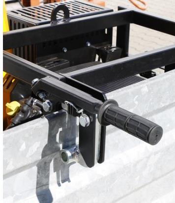
Laubsauger mit Arretiermechanismus an der Bordwand
