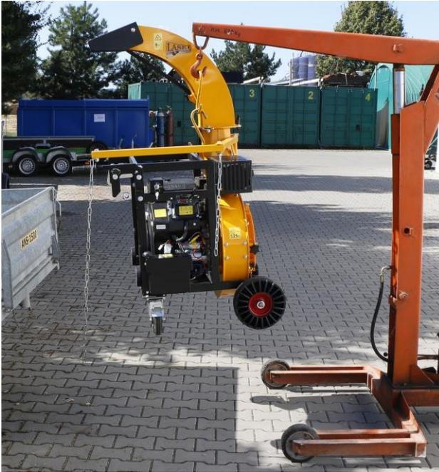
Aufheben des Laubsaugers am Hebezeug
