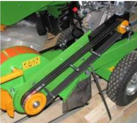
Riementrieb bei SW Ausführung
