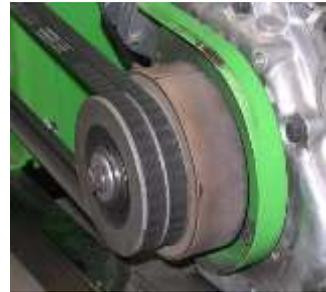
Riementrieb bei SWC Ausführung
