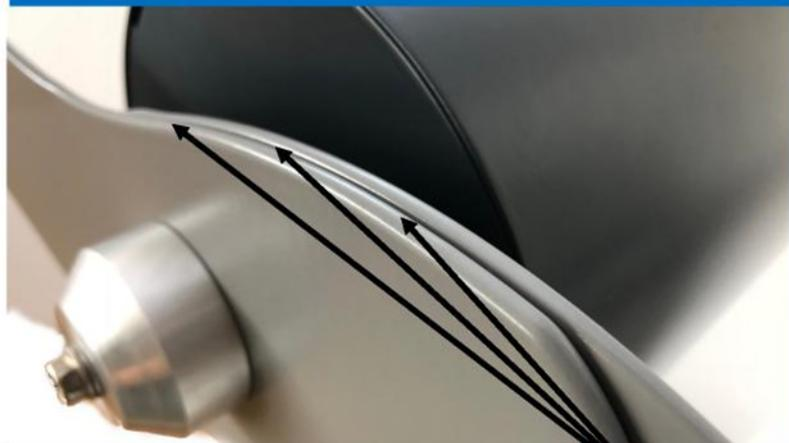
Veillez impérativement à ce que **les deux pales du rotor soient bien superposées** ! Tout écart est synonyme de déséquilibre et entraîne des bruits de nacelle et des dommages matériels pouvant aller jusqu'à la rupture du rotor ! Le simple fait de l'emboîter à l'aide de la rainure ne suffit pas !
