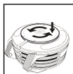
fig. 12 - monter le cache
