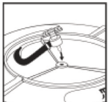
fig. 10 - montare il raccordo girevole
