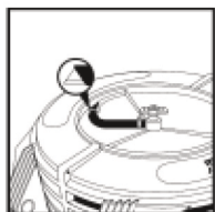
fig. 5 - remove cable tie
