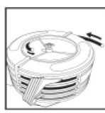
fig. 8 - mettre le nouveau tuyau en place
