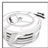
fig. 7 - rimuovere il tubo flessibile
