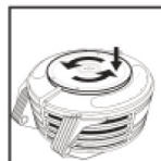
fig. 12 - montare il coperchio
