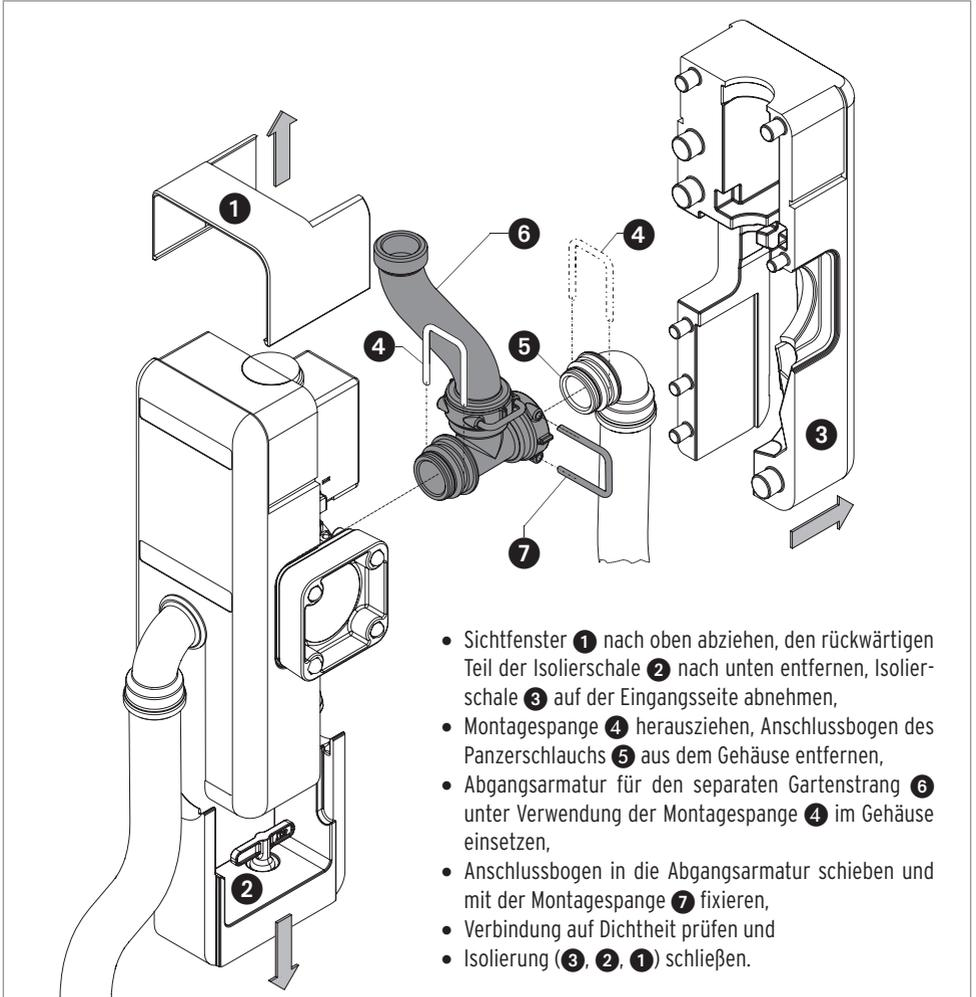
**Hinweis:** Geben Sie vor Inbetriebnahme der Abgangsarmatur für einen separaten Gartenstrang die entsprechenden Punkte in der Menüstruktur der verwendeten Enthärtungsanlage ein. Beachten Sie die Gebrauchsanleitung des Gerätes.
