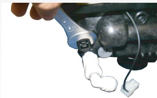
Demontieren Sie mit einem Maulschlüssel (SW 19) die Chlorzelle aus dem Steuerkopf.
