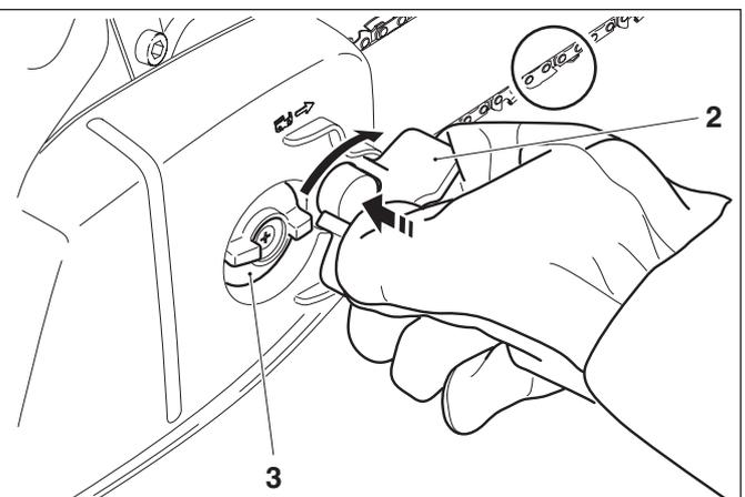
Kettenradschutz-Schnellspanner loslassen (entlasten), bis frei drehbar, dann wie in Bild dargestellt zwischen den Schutzrippen (15) einklappen.
