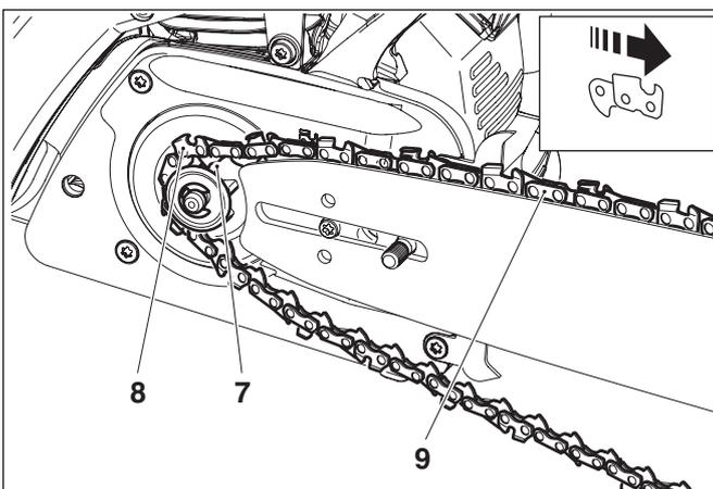
Sägekette (8) um den Umlenkstern (10) der Sägeschiene führen, dabei Sägekette leicht in Pfeilrichtung ziehen.
