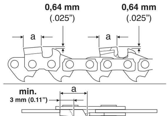
Der Schärfwinkel ( $\alpha$ ) muss bei allen Hobelzähnen unbedingt gleich sein.
