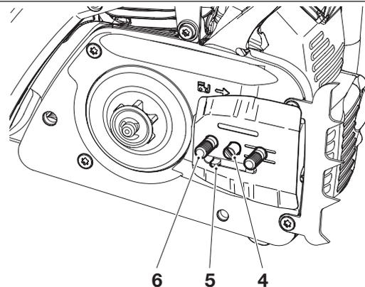
Sägeschiene (7) aufsetzen. Darauf achten, dass der Zapfen (5) des Kettenspanners in das Loch der Sägeschiene eingreift.
