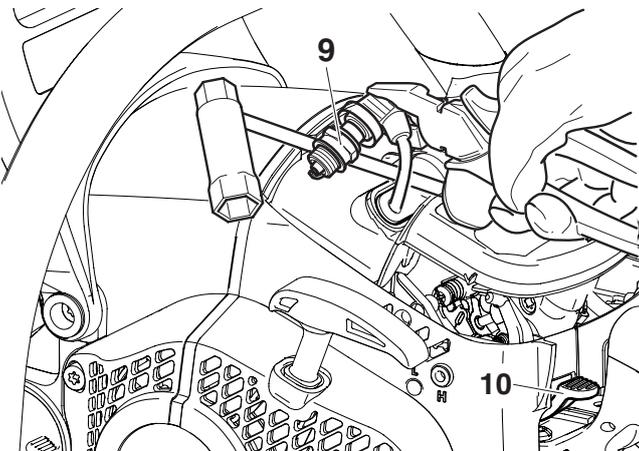
Kombischlüssel zwischen Haube und Zylinder wie im Bild gezeigt stecken.
