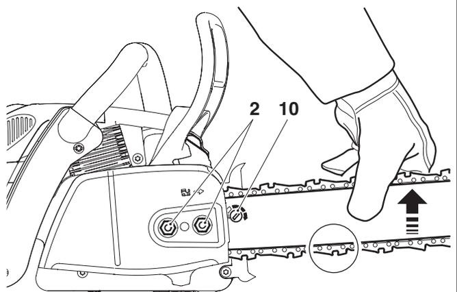
**Kontrolle der Kettenspannung**
