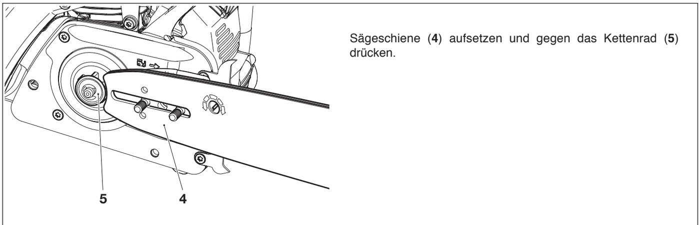
Sägeschiene (4) aufsetzen und gegen das Kettenrad (5) drücken.
