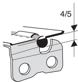
Ein Feilenhalter erleichtert die Feilenführung, er besitzt Markierungen für den korrekten Schärfwinkel von:
