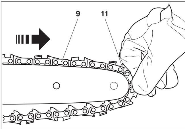
Sägekette (9) um den Umlenkstern (11) der Sägeguide führen, dabei Sägekette leicht in Pfeilrichtung ziehen.
