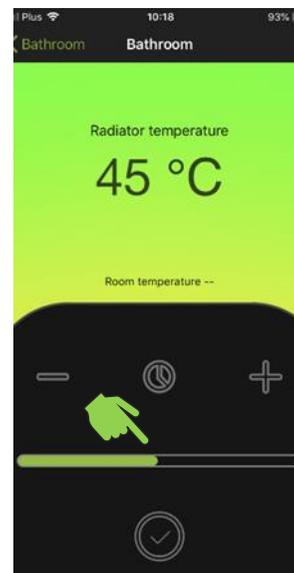
**Schritt 3: Drücken Sie das Timer-Symbol**, um das Menü zur Aktivierung und Einstellung des Timers aufzurufen.
