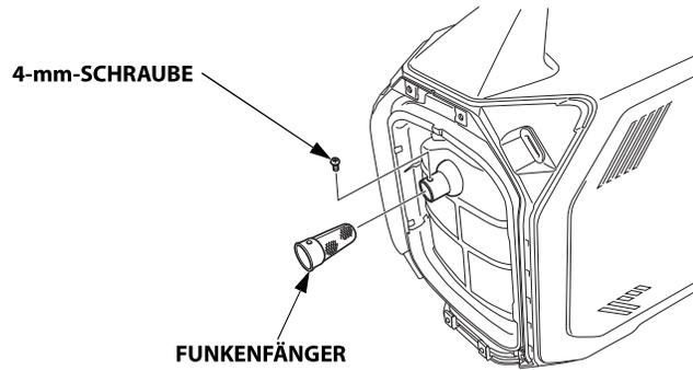
3. Mit einer Bürste Kohleablagerungen vom Funkenfängersieb entfernen.
