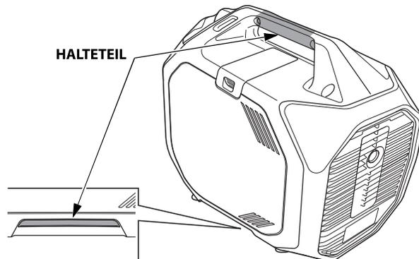
Beim Abstellen des Generators auf ein Fahrzeug einen Ort vermeiden, der direkter Sonneneinstrahlung ausgesetzt ist. Wenn der Generator viele Stunden in einem geschlossenen Fahrzeug gelassen wird, kann die hohe Temperatur im Fahrzeuginneren dazu führen, dass Kraftstoff verdampft. Das kann zu einer möglichen Explosion führen.
