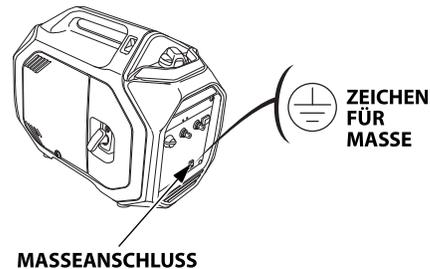
Ein Gerät mit einem Masseleiter mit einem Verlängerungskabelset mit einem Masseleiter anschließen. Zur Bestimmung des Massestifts im Stecker die Buchsenseite auf Seite 76 aufschlagen.
