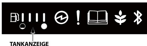
Anhand der Kontrollleuchte wird der Kraftstoffstand des Generators wie folgt angezeigt:
