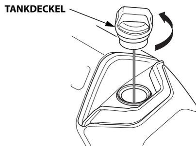
2. Vorsichtig tanken, um kein Kraftstoff zu verschütten. Nicht mehr in den Kraftstofftank füllen als über die obere Füllstandsmarkierung (rot) am Kraftstoffsieb hinaus.
