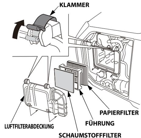
4. Prüfen, ob der Schaumstofffilter sauber und in gutem Zustand ist. Wenn der Schaumstofffilter verschmutzt ist, wie auf Seite 57 beschrieben reinigen. Den Schaumstofffilter austauschen, wenn er beschädigt ist.
