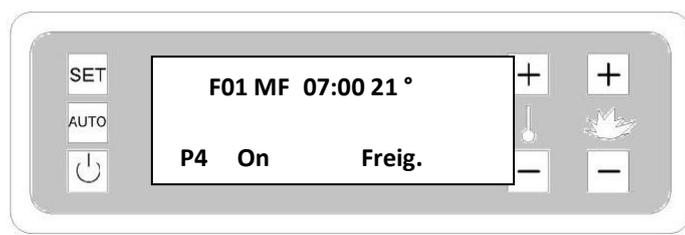
**Bestätigen Sie mit der SET-Taste und der Bildschirm zeigt automatisch F02 an, die zweite Programmierung.**
