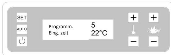
Um den Ofen anzuzünden, müssen Sie die Ein-/Aus-Taste einige Sekunden lang drücken. Der Ofen wechselt automatisch in die Zünd- und Aufheizphase. Bei der ersten Zündung und der ersten Pelletsfüllung müssen mehrere Zündzyklen durchgeführt werden, damit die Pellets in den Zufuhrkreislauf gelangen.
