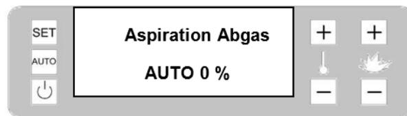
Das Display zeigt „Auto“ an, weil der Ofen mit einem System zur automatischen Steuerung der Drehung des Rauchabzugsmotors ausgestattet ist und der Benutzer die Werte nicht ändern kann.
