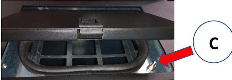
Bei zu hoher Schließung bleibt der Schalter C nicht gedrückt, daher wird Alarm 6 ausgelöst.
