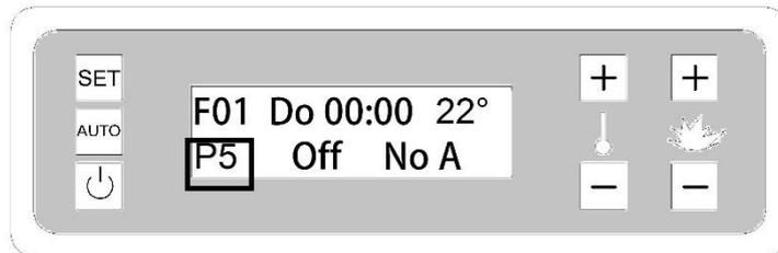
Wir empfehlen, den Ofen auf mittelhohe Leistung einzustellen, da die Elektronik die Leistung moduliert, wenn der Ofen die eingestellte Temperatur erreicht hat.
