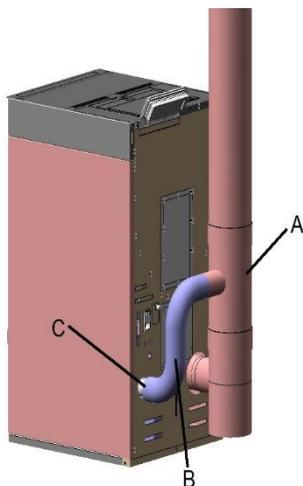
Der Anschlussschlauch „B“ muss aus einem Material bestehen, das der Temperatur von mindestens 200°C standhält.
