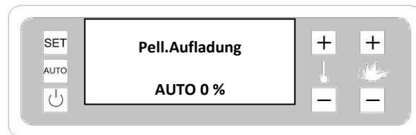
Das Display zeigt "Auto" an, da der Ofen mit einer automatischen Pelletsdosierung ausgestattet ist, wird der Korrekturprozentsatz angezeigt, aber der Benutzer kann die Werte nicht ändern.
