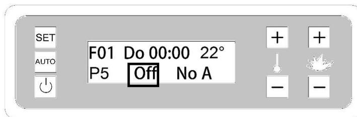
Drücken Sie die Taste PROG + und das Display blinkt NO A. (deaktiviert) / aktiviert. (Ermöglicht)
