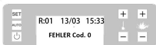
**R** ist die Anzahl der Ereignisse (von 1 bis 10), 03/13 ist das Datum des Ereignisses (Tag / Monat), 15.33 Uhr Uhrzeit des Ereignisses und unterhalb des Displays wird die Art des Alarms (cod. 0) angezeigt, alternativ we Lesen Sie, was der Alarm genau macht. Mit den PROG +/- Tasten können Sie durch die Alarmer blättern.
