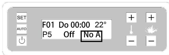
Diese Konfiguration ermöglicht es uns, die gespeicherte Programmierung zu aktivieren oder zu deaktivieren. Auf diese Weise können wir Zeitpläne mit unterschiedlichen Zeiten speichern und entscheiden, welche verwendet werden sollen. Wenn die Programmierung aktiviert (Enabled) ist, wird sie natürlich ausgeführt, andernfalls wird sie ignoriert (No A).
