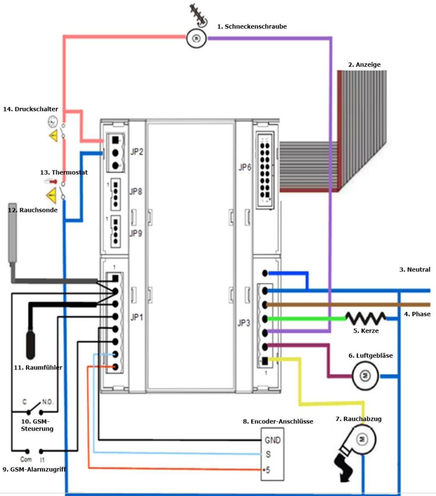
**Anschlüsse der Elektronikplatine**
