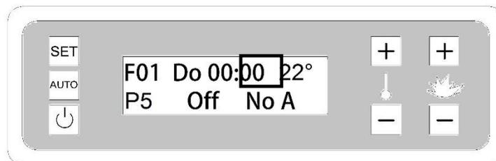
Drücken Sie die Taste Prog +, um zur Temperatur zu wechseln.
