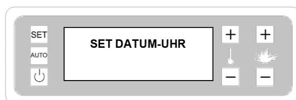
Scrollen Sie mit der Taste Temp +, bis der Bildschirm Parameter anzeigt:
