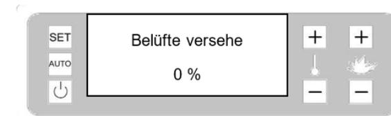
Mit den Tasten TEMP +/- können Sie die Belüftung mit Werten von - 50% bis + 50% ändern.
