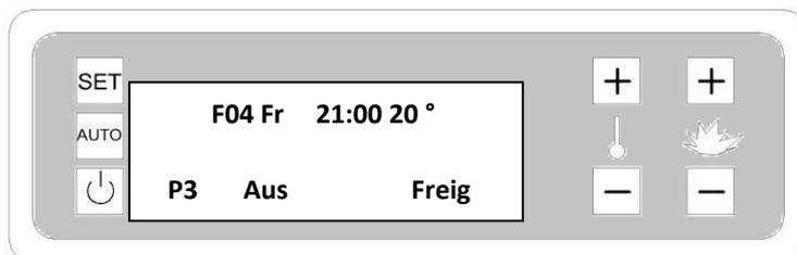
➤ Bestätigen Sie mit SET und drücken Sie die Ein-/Aus-Taste, um das Programm zu verlassen.
