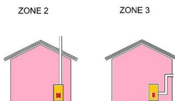
Die Zonen 2 und 3 mit vertikaler oder horizontaler Anordnung müssen über einen geschlossenen Verbrennungskreislauf verfügen und unter die DTA der Systeme zur Evakuierung von Verbrennungsprodukten und Pelletsgeräten fallen.
