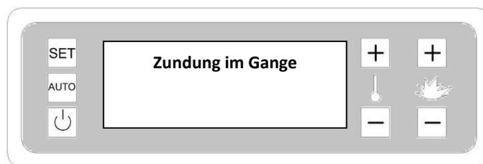
Diese wird bis zum Ende des Zündzyklus angezeigt; Am Ende des Zyklus zeigt das Display:
