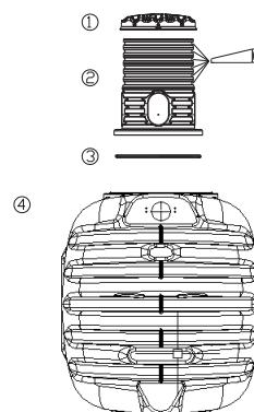
Die Schachtverlängerung ist an den Rillen kürzbar. Dadurch können Erdüberdeckungen über Tankschulter von 400 bis 780 mm realisiert werden.
