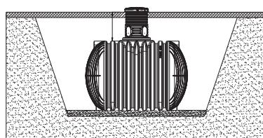
No instalar los tanques debajo de viales.
