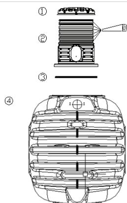
La rehausse est ajustable en hauteur pour un remblai de 400 à 780mm.
