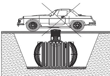
Les cuves ne doivent pas être installées dans la nappe phréatique. Toutes infiltrations ou écoulements doivent être drainés.
