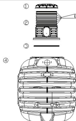
La extensión de cúpula se puede acortar en las ranuras. De este modo se pueden realizar coberturas con tierra sobre el hombro del tanque desde 400 hasta 780 mm. Para montar la extensión de cúpula ② hay que colocarla suelta sobre la abertura del tanque ④ y montar antes la junta ③ incluida en el suministro. No es necesario fijar la extensión. Una vez rellenada la excavación la tierra mantiene la arqueta en su posición.
